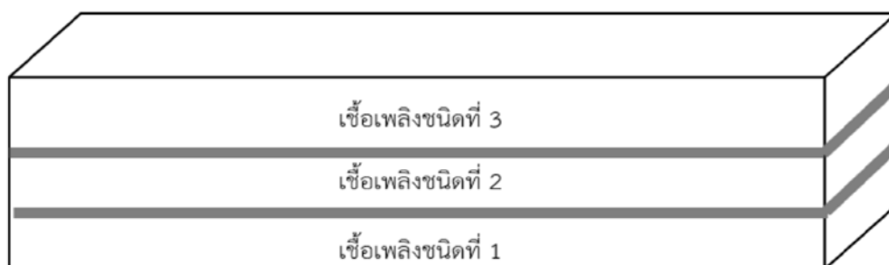
รูปที่ 2.6-3 ภาพลักษณะการแบ่งชั้นในการปูเชื้อเพลิงชีวมวล
